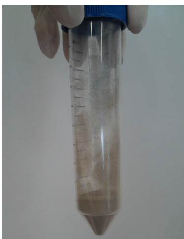
Figura 30-Lenhina kraft extraída e purificada em laboratório.
